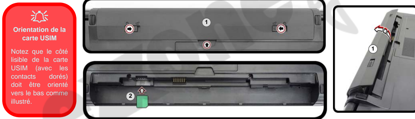
Figure 19 - Retirer la batterie et insérer la carte USIM
